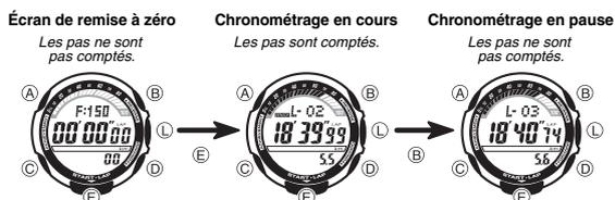
**SENSOR :** L'indicateur **SENSOR** apparaît sur l'afficheur lorsque la montre est en cours de chronométrage. L'indicateur clignote quand les pas sont comptés.
