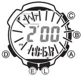
1. Halten Sie im Höhenmessmodus (E) gedrückt, bis der Wert der aktuellen Bezugshöhe zu blinken beginnt. Dies ist die Einstellungsanzeige.
