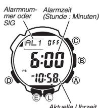
Sie können fünf voneinander unabhängige tägliche Alarmer einstellen. Wenn ein Alarm eingeschaltet ist, ertönt täglich etwa 10 Sekunden lang ein Alarmton, wenn die Uhrzeit des Uhrzeitmodus die eingestellte Alarmzeit erreicht. Dies ist auch der Fall, wenn die Uhr nicht auf den Uhrzeitmodus geschaltet ist. Sie können auch ein Stundensignal einschalten, bei dem die Uhr jede volle Stunde durch zweimaliges Piepen meldet.
