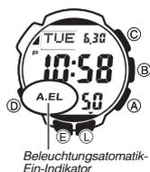
Halten Sie im Uhrzeitmodus etwa drei Sekunden lang **(L)** gedrückt, um die Beleuchtungsautomatik ein- (**A.EL** angezeigt) bzw. auszuschalten (**A.EL** nicht angezeigt).
