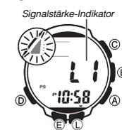
Während des manuellen Empfangs zeigt der Signalstärke-Indikator wie unten gezeigt die Signalstärke an.
