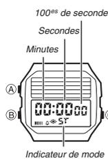
Le mode Chronomètre permet de mesurer le temps écoulé, des temps intermédiaires et deux arrivées. La plage de chronométrage est de 59 minutes, 59,99 secondes.
